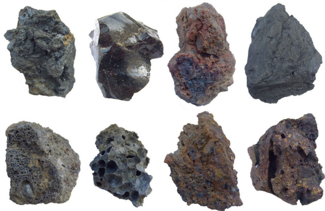
Abb. 4: Auswahl verschiedener anthropogener Substrate im Boden aus Abb. 3. Oben (v. l.): Bleischlacke, Gießereischlacke, Asche, Bergematerial. Unten: verschiedene Schlacken (2011, T. KASIELKE).
