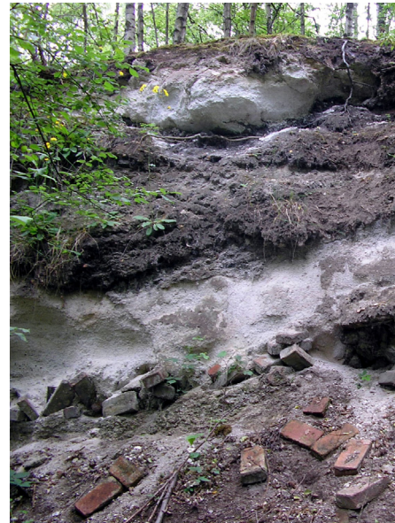
Abb. 24: Gichtgasschlamm über Bauschutt und Bergematerial im Landschaftspark Pluto-Wilhelm in Herne-Wanne (2008, P. GAUSMANN).
